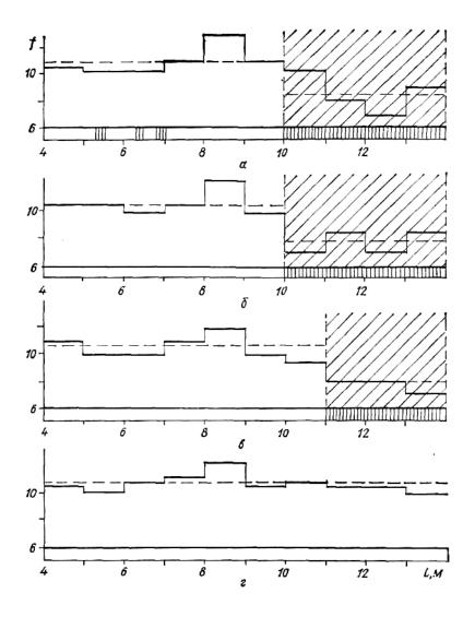
Рис. 4. - Характер изменения крепости песчаника по длине скважин, пробуренных вне зоны влияния очистных работ (а), за 10 м до подхода лавы (б), в 10 (в) и 40 (г) м после прохода лавы
