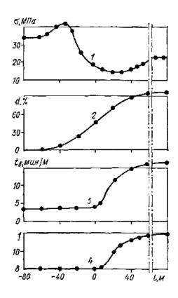
Рис. 1.- Характер изменения напряжений (1), степени дегазации (2), буримости (3) и крепости (4) пород в массиве выбросоопасного песчаника при его надработке лавой
