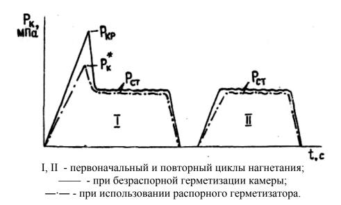
Рис. 2. – Изменение давления рабочей жидкости в нагнетательной камере при гидравлическом разрыве.
