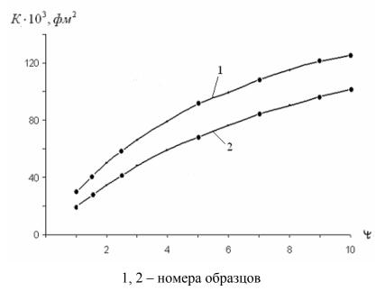
Рис. 6. - Изменение газовой проницаемости образцов горных пород при переходе из равнокомпонентного объемного напряженного состояния в разнокомпонентное.
