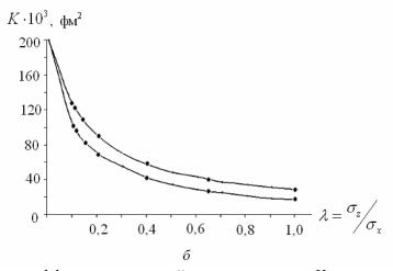
Рис. 5. – Изменение коэффициента газовой проницаемости K различных образцов песчаника: а – в зависимости от внешней нагрузки  $\sigma$ ; б – от коэффициента  $\lambda$
